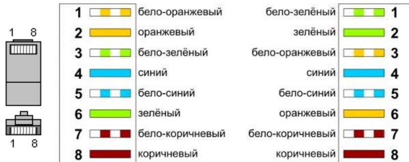
Рисунок 6 – Внешний вид коннектора RJ-45 с нумерацией контактов
